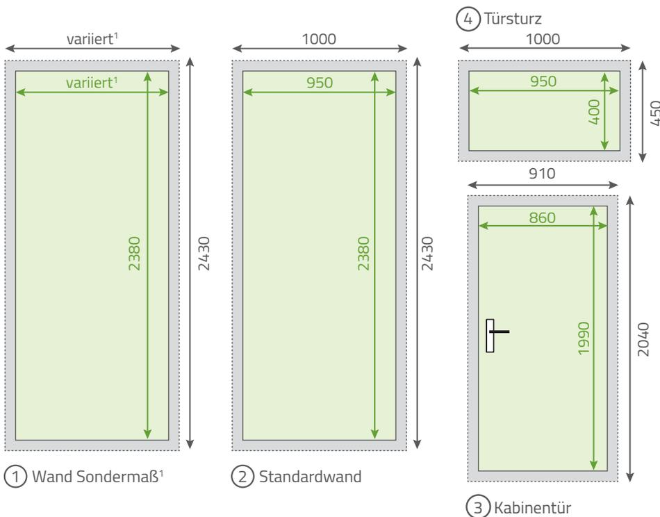
2) Türsturz ist mit Oberkante Standardwand bündig, Abstand zw. Türsturz und Türblatt = 70 mm (ausgehend vom Sichtmaß).
